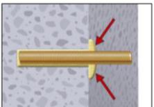
9. Nach der Installation des Ankers muss der Ringspalt komplett mit Mörtel ausgefüllt sein. Tritt keine Masse nach Erreichen der Verankerungstiefe heraus, ist diese Voraussetzung nicht erfüllt und die Anwendung muss vor Beendigung der Verarbeitungszeit wiederholt werden. Bei Überkopfmontage ist die Ankerstange zu fixieren (z.B. Holzkeile).
